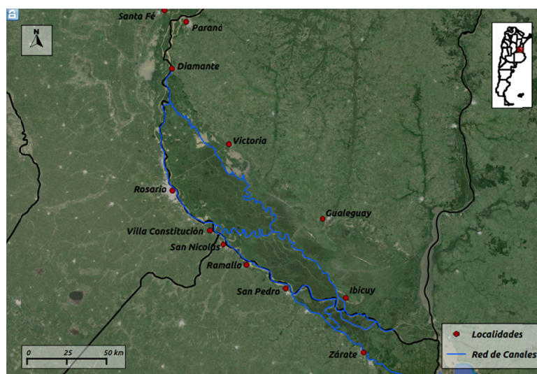
Figura 4: Topología de la red de canales adoptada
