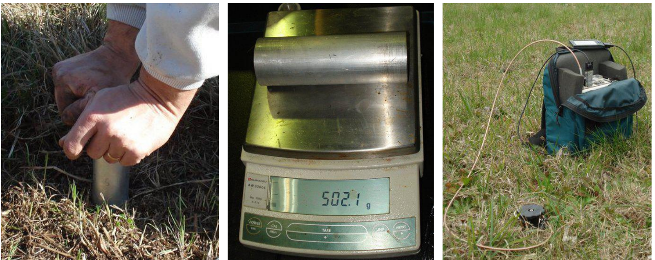
Figura 2.- (Izquierda) Toma de la muestra gravimétrica. (Centro) Pesando la muestra. (Derecha) Tomando la medición con el instrumento TDR.
