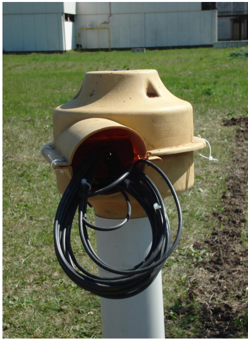
Figura 1.- Punto de acceso a los sensores enterrados a diversas profundidades.
