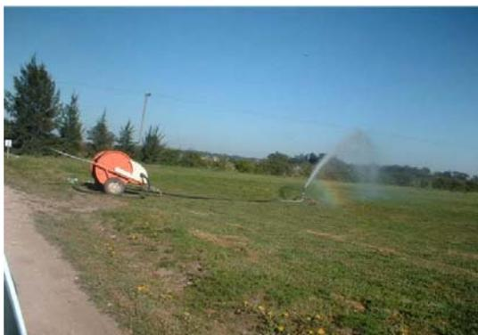
Figura 7: Riego por aspersión (cañón con enrollador) para producción de césped.
