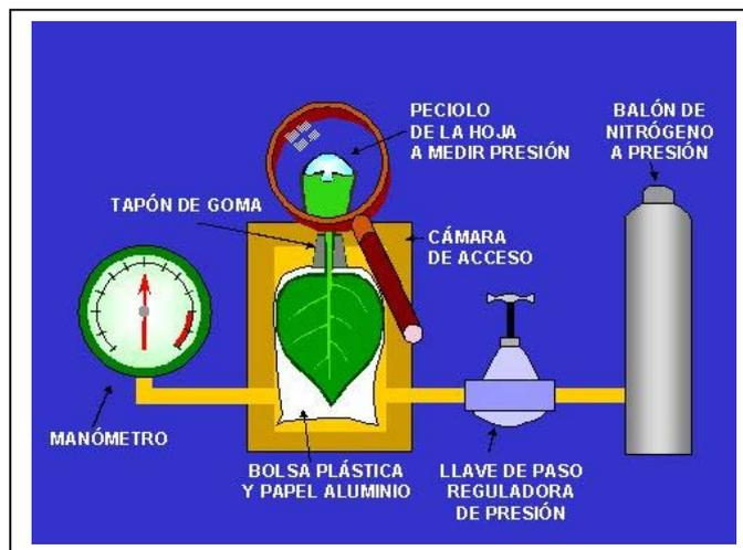
Figura 19. Representación esquemática de una cámara de presión
