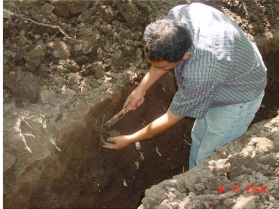
Figura 14.- Control de humedad de suelo mediante calicatas
