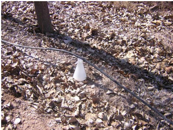
Determinación de coeficiente de uniformidad de riego por goteo
