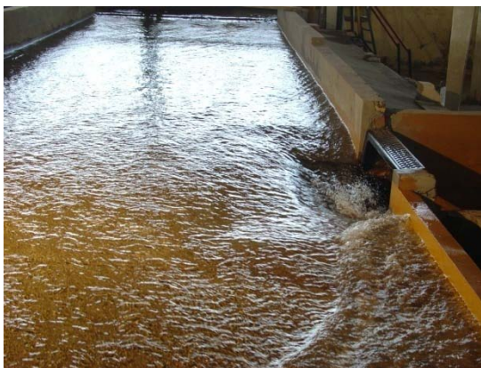
Capacidad de captación Rejas O.S.N. + Tipo Ventana Pendiente S_o = 0.5\%
