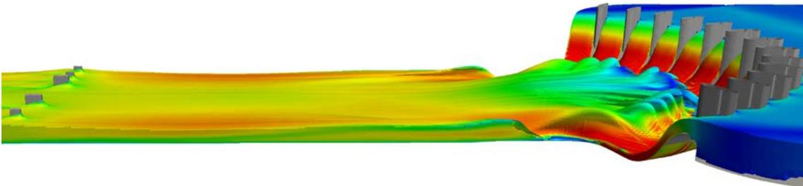
Modelación CFD del vertedero y el puente sobre la rápida
