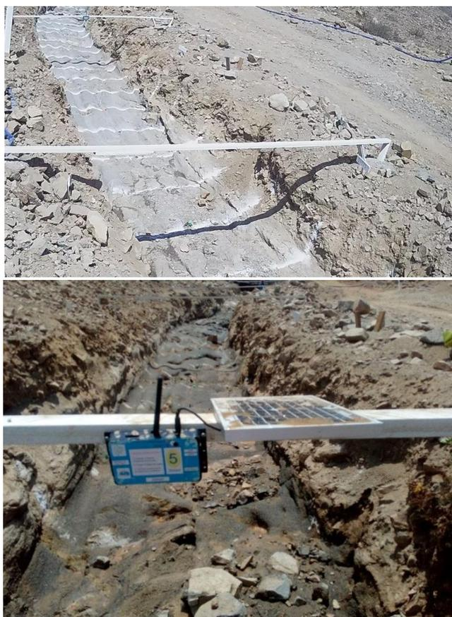
**Figura 3.-** Estacado y seccionamiento del cauce con el reticulado transversal del cauce, para su filmación con el circuito cerrado de TV (foto superior). Vista del sensor de ultrasonido con panel solar de las secciones de control para medición de tirantes del flujo (foto inferior).
