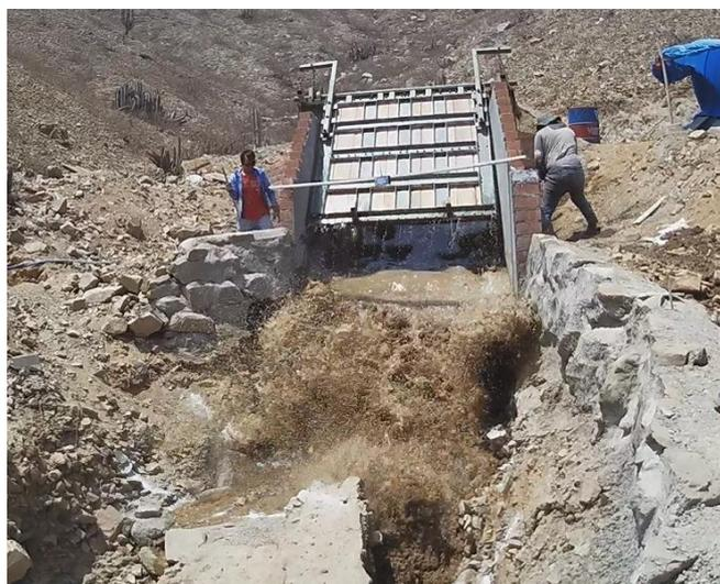
**Figura 2.-** Vista desde aguas abajo de la liberación súbita del volumen finito de la mezcla bifásica y generación de la onda de huayco.
