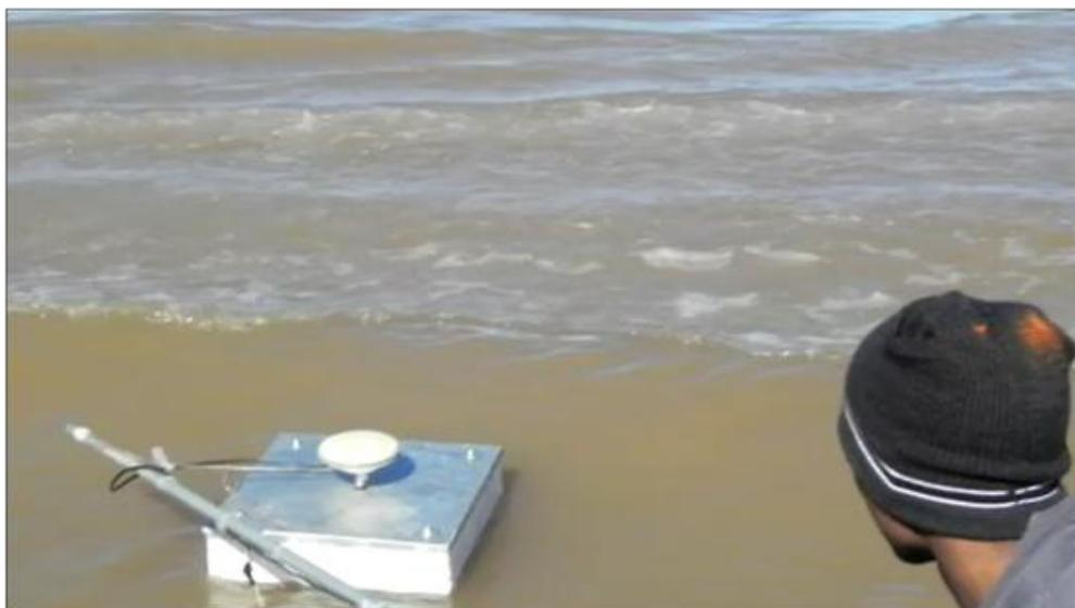
**Figura 4.-.** Sensor Altimétrico flotante.
