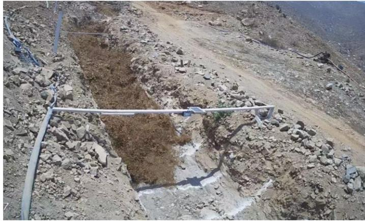
**Figura 4.-** Vista desde aguas abajo de un evento experimental del tránsito del frente de onda del flujo de huayco en el tramo experimental de la quebrada.
