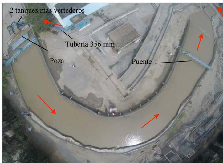
**Figura 2.-** Modelo físico del río Madre de Dios en el Laboratorio Nacional de hidráulica.
