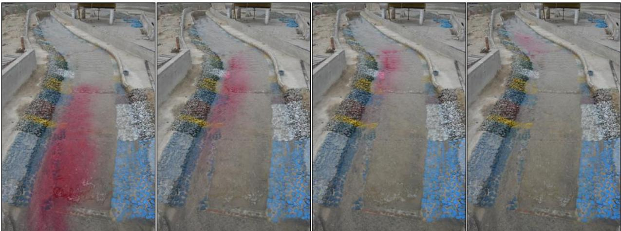
**Figura 3.** Trazador color rojo colocado de la margen izquierda para visualizar los patrones de flujo para un caudal de 75 l/s. Fuente: Kuroiwa (2018)
