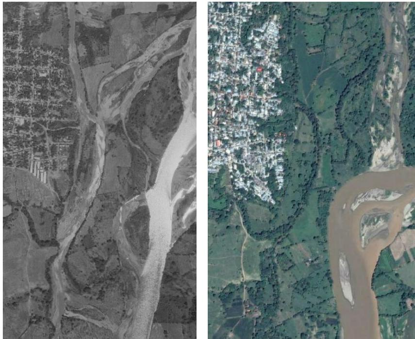
**Figura 7.-** Cambio en el alineamiento del río Magdalena en el municipio de Aipe entre 1987 y 2016
