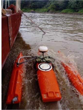
**Figura 4.-** Dispositivo ADCP empleado en las mediciones en campo
