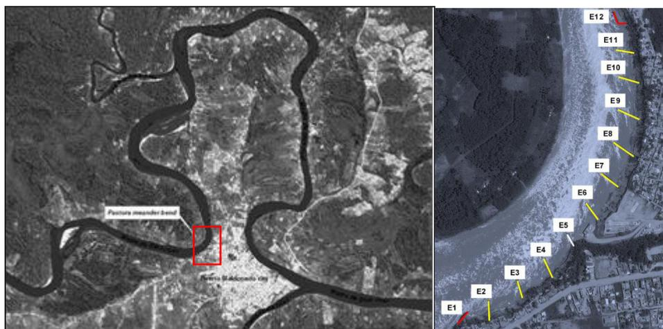
**Figura 1.-** Curva La Pastora – Río Madre de Dios. *Izquierda:* Ubicación; *Derecha:* Disposición de espigones
