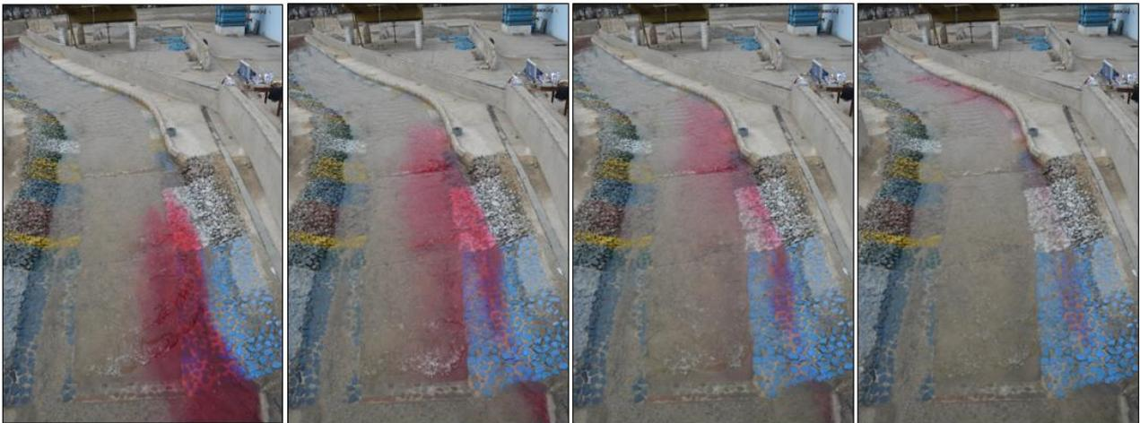
**Figura 2.** Trazador color rojo colocado de la margen derecha para visualizar los patrones de flujo para un caudal de 75 l/s. Fuente: Kuroiwa (2018)
