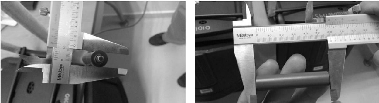
**Figura 6.-** Dimensiones de la pila circular colocada en el canal experimental
