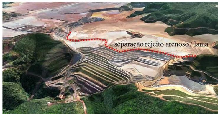
**Figura 2.-** Imagem aérea da Barragem do Fundão. Fonte: Adaptado de Morgenstern *et al.* (2016)
