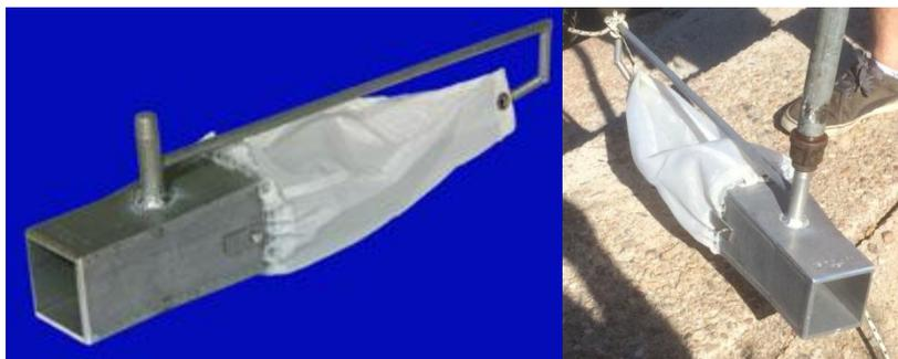
**Figura 1.-** Muestreador de transporte por fondo F.I.S.P. US-BL 84.
