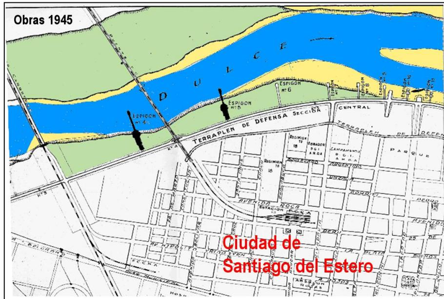
Figura 3. Obras de Control en la Margen Derecha del Río (1945)
