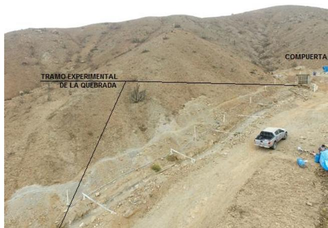
**Figura 1.-** Vista del tramo experimental de la quebrada con la instalación del circuito cerrado de TV y el sistema de sensores de ultrasonido en las secciones de control en el cauce.
