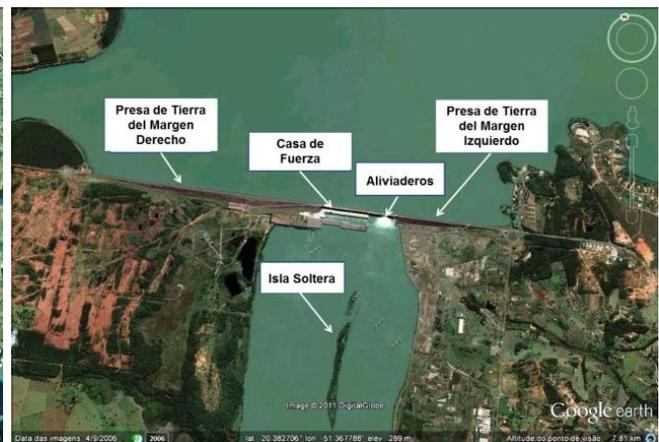
**Figura 2.-** Principales Unidades de la Central Hidroeléctrica *Ilha Solteira* (Andrade, 2013)
