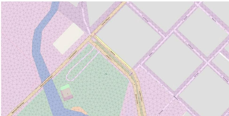
**Figura 3.-** Malla de TIN en una parte del dominio, con huecos para las manzanas de la ciudad, realizada con el mallador Gmsh para QGIS.
