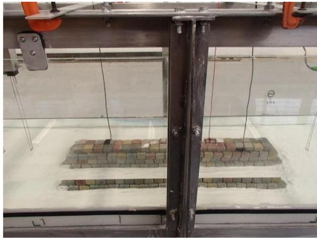
**Figura 2.** Ensayo de la estructura sumergida sobre el suelo fino en el canal de oleaje.
