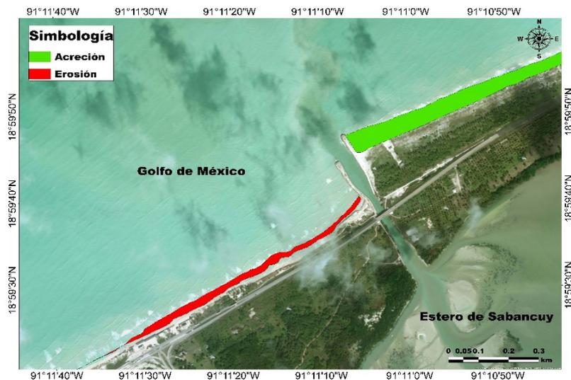
**Figura 3.-** Detalle de las áreas de acreción y erosión en la zona del canal de acceso.
