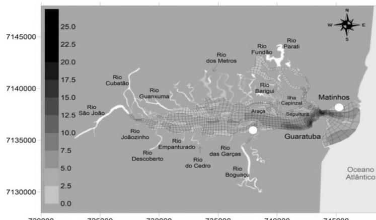
**Figura 2.-** Domínio de modelagem para a baía de Guaratuba, mostrando a malha com 4275 nós e 936 elementos, a visualização da topografia de fundo do domínio de modelagem e a localização dos rios e das fontes de lançamento do esgoto sanitário (círculos).
