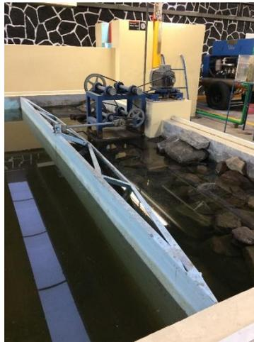
**Figura 2.-** Sistema de poleas y paleta tipo *flap*
