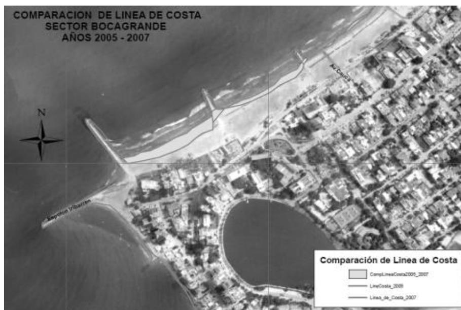
**Figura 6.-** Variación de la línea de costa en el sector de Bocagrande entre los años 2005 (línea gris claro) y 2007 (línea gris oscuro). En este período se presenta erosión en el sector con una disminución del ancho de playa seca entre 15 y 22m.
