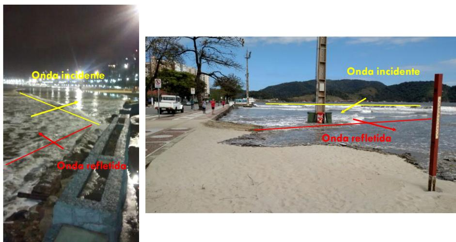
**Figura 5.-** Incidência de ondas na região da Ponta da Praia
