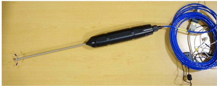
**Figura 7.-** Dispositivo *Vectrino Velocimeter*
