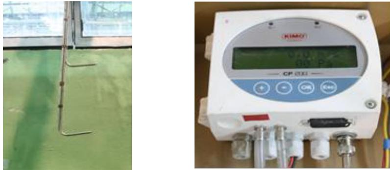
**Figura 9.** Tubos de Pitot y acondicionador analógico/digital de la señal de viento
