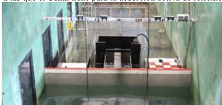
**Figura 8.** Sondas para la medida del remonte, para caracterizar el oleaje incidente y reflejado
