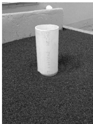
Figura 1.- Vista de la pila circular y foso de socavación después del ensayo.
