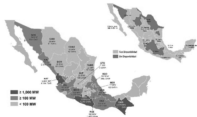
Figura 3.- Capacidad instalada (MW) y generación en centrales hidroeléctricas (GWh) 2016 y mapa de disponibilidad hídrica.
