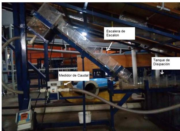
Figura 1.- Banco Experimental: Escalera Hidráulica de Escalón.
