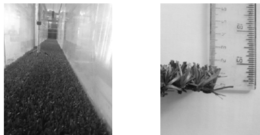
Figura 2. - Fondo de pasto sintético flexible en el canal de pendiente variable. Altura de racimo de pasto.
