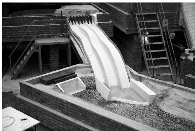
Figura 3.- Canales de descarga y cuenco de resalto.
