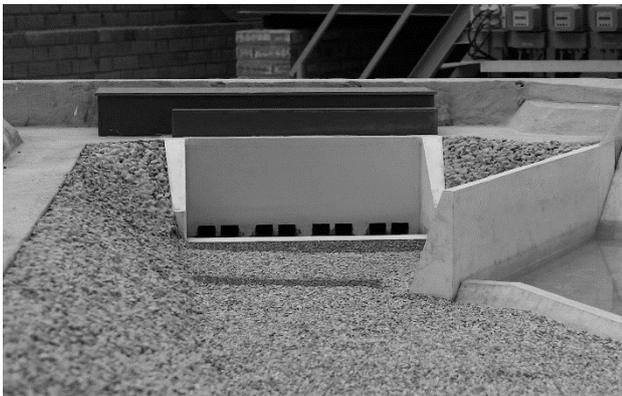
Figura 3.- Estructura de salida de la central de turbinas.
