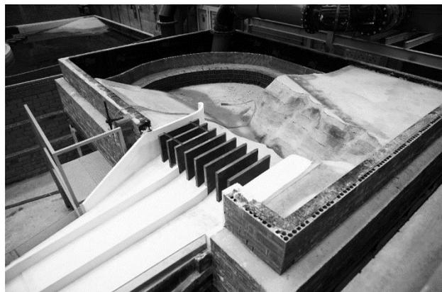
Figura 2.- Zona de alimentación al aliviadero en el modelo físico.
