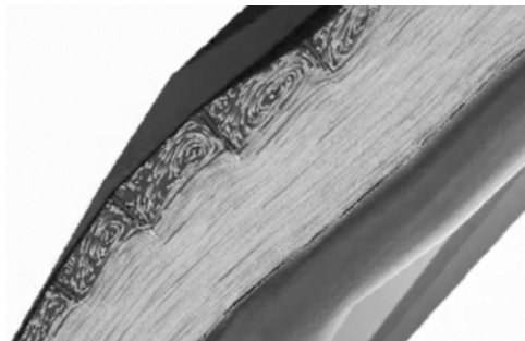
Figura 3.- Generación de vórtices entre direccionadores a partir de la modelación numérica (Muestra) (HEC-RAS 5.0.3)
