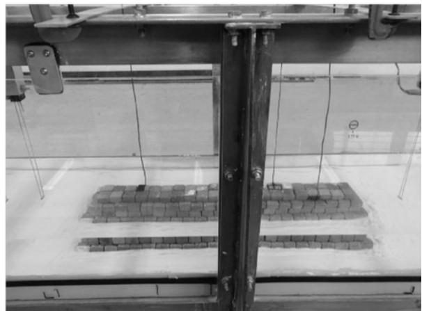
Figura 1.- Ensayo de la estructura sumergida sobre el suelo fino en el canal de oleaje.
