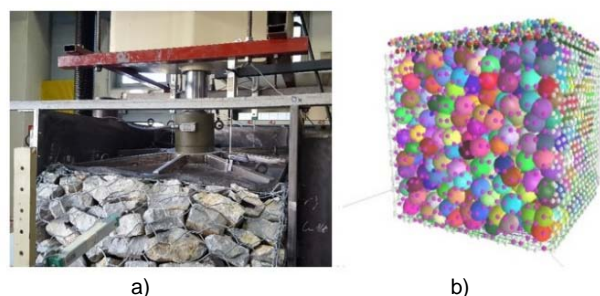
Figura 6.- Estudio de la capacidad carga de los gaviones: a) modelo experimental; b) modelo numérico (SANTOS JUNIOR, 2018).
