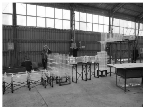
Figura 1.- Modelo físico de la cámara disipadora,
