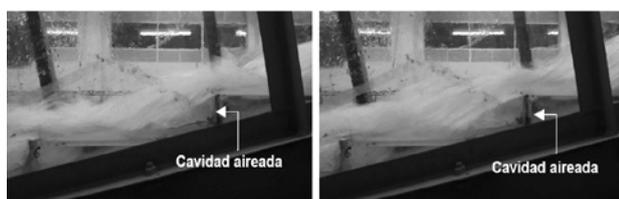
Figura 3.- Comportamiento hidráulico de flujo saltante.
