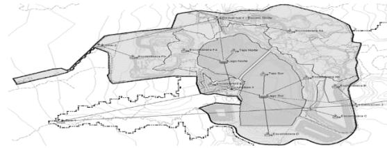
Figura 4.- Esquema general de la modelación del llenado del tajo a nivel diario en HEC-HMS.
