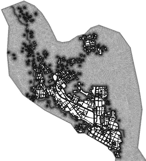
Figura 1.- Malla no estructurada empleada para la modelación.
