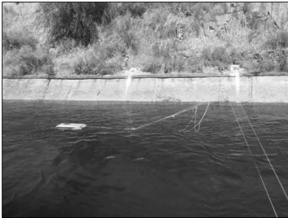
Figura 3.- Ejecución de aforo con perfilómetro Doppler sobre el Canal de Orellana.
