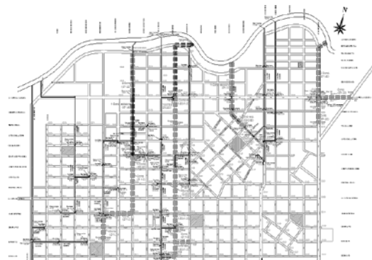
Figura 3.- Plan de obras de drenaje de Arroyito.
