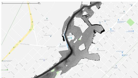
**Figura 2.-** Diferencia de la superficie máxima de inundación (contorno negro en los bordes) entre Iber y RiverFlow2D en un mallado no estructurado TIN de lado promedio 5 metros.
