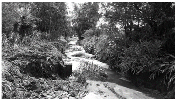
Figura 5.- Vista da erosão com arraste da vegetação e o transporte de sedimentos no canal do Ribeirão Taiacupeba-Mirim, durante a realização dos testes com vazão restrita a 0,8 \text{ m}^3/\text{s} . (Autores, 2015).
