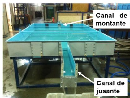
Figura 1.- Reservatório retangular instalado no CPH-UFGM, Brasil.
