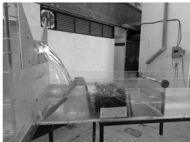
Figura 2.- Vertedor triangular y su tranquilizador.
