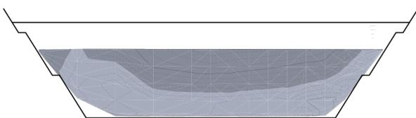
Figura 4.- Distribuição da componente de velocidades transversal  $v$  na seção D (próximo à superfície, com sentido para a margem direita, e, junto ao fundo, com sentido para a margem esquerda).
