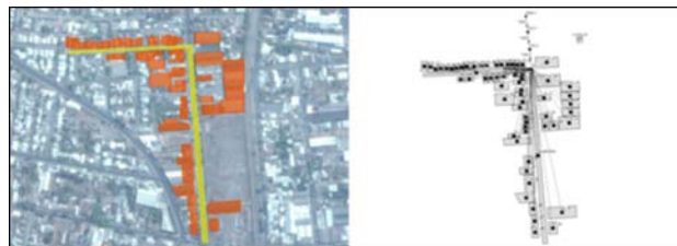
Figura 1.- Caso de estudio: a) Delimitación superficies en Google Earth; b) Construcción del modelo en SWMM
