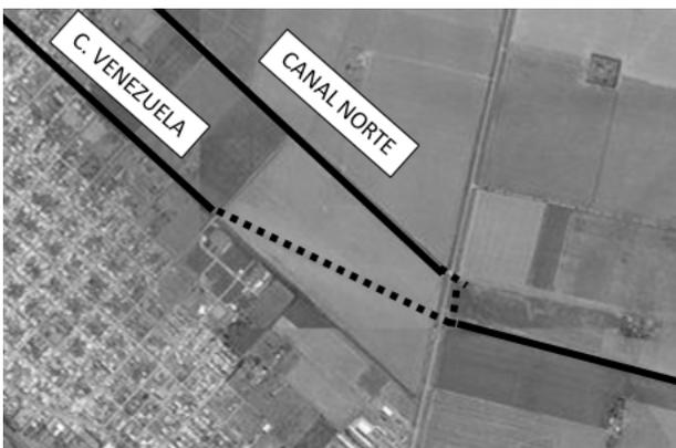
Figura 4.- Sistema de drenaje propuesto.
