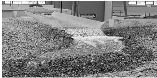
Figura 3.- Vertedor 2, con un gasto de 1,360.91 m 3 /s
