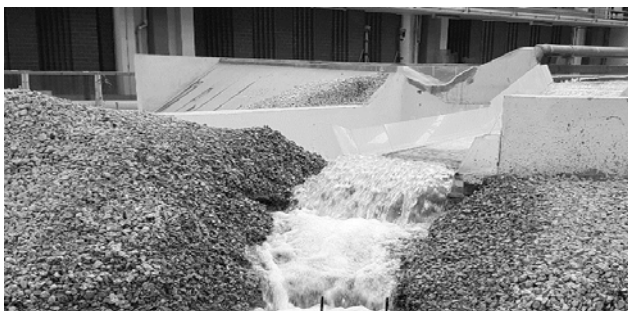
Figura 2.- Vertedor 1, con un gasto de 3,099.4 m 3 /s.
