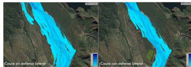
Figura 6.- Superficie de inundación sin y con la defensa en la margen derecha del cauce.
