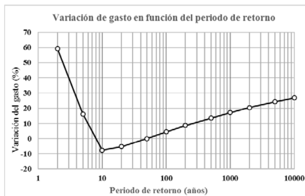
Figura 4.- Variación del gasto calculado con el criterio 2 respecto a los obtenidos con el criterio 1.
