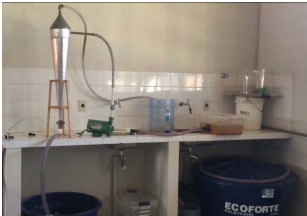
Figura 2.- Hidrociclone em funcionamento.
