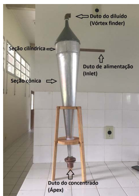
Figura 1.- Composição do hidrociclone.
