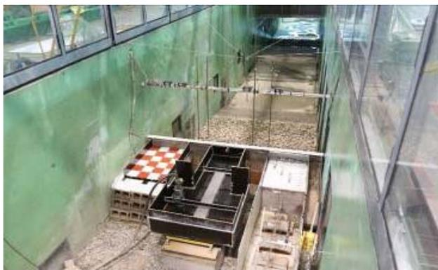
Figura 2.- Dique vertical. Ensayo 1:15 con viento. Vista general.
