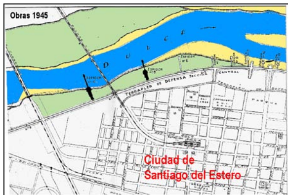
Figura 3.- Obras de Control en la Margen Derecha del Río.
