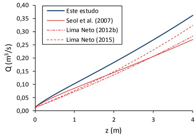
**Figura 5.-** Comparação da vazão de circulação simulada pelo modelo proposto e aquelas obtidas com modelos disponíveis na literatura.
