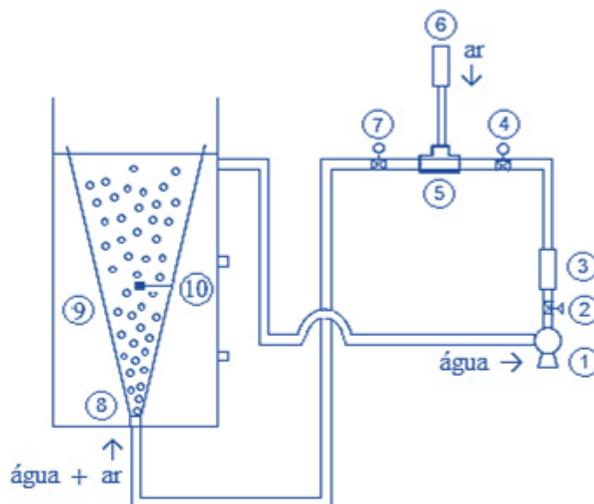
**Figura 1.-** Esquema experimental: 1 – bomba centrífuga; 2 – válvula do tipo globo; 3 e 6 – rotâmetros; 4 e 7 – manômetros; 5 – injetor Venturi; 8 – bocal de entrada; 9 – jatos bifásicos; 10 – anemômetro eletromagnético.
