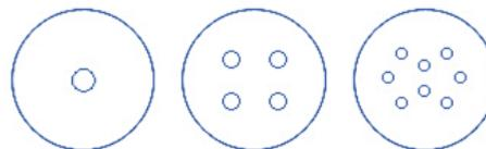
**Figura 2.-** Bocais utilizados nos experimentos: (a) Tipo A – 1 orifício com 10 mm de diâmetro; (b) Tipo B – 4 orifícios com 5 mm de diâmetro cada; e (c) Tipo C – 8 orifícios com 3,5 mm de diâmetro cada.
