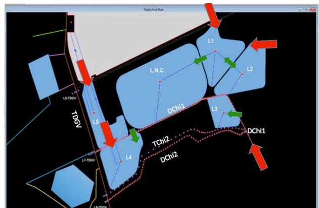
Figura 2.- Elementos del modelo en EPA-SWMM.
