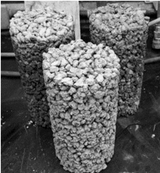
Figura 2.- Amostras de concreto permeável.
