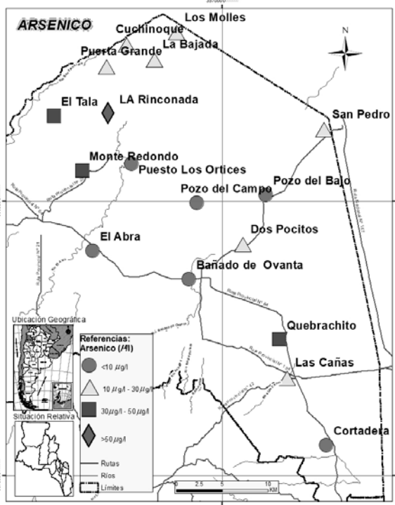
Figura 3.- Concentraciones medias de Arsénico en las perforaciones monitoreadas del departamento Santa Rosa.
