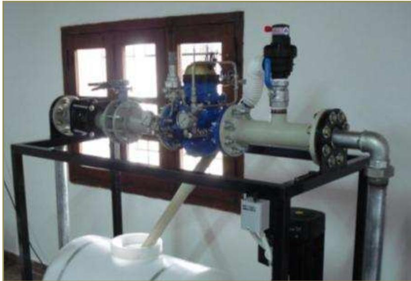
Los principales accesorios son una válvula de aire, una válvula de corte (tipo Mariposa) y un hidrómetro que además regula presión aguas abajo. La presión aguas arriba esta generada por una bomba.
