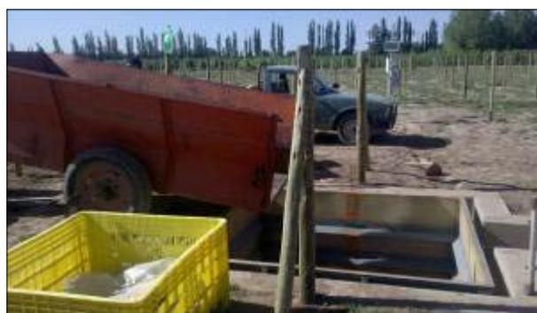
Fig. 5: Llenado del tanque lisímetro
