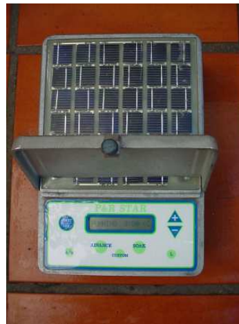
Foto nº 3: controlador con microprocesador
