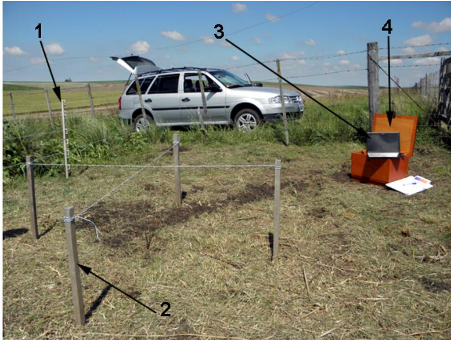
Figura 5: Sitio de medición operativo. 1 Varillaje perimetral; 2 Estacas de posicionamiento (monografía) del punto de medición; 3 Notebook; 4 Abrigo para conectores y batería.
