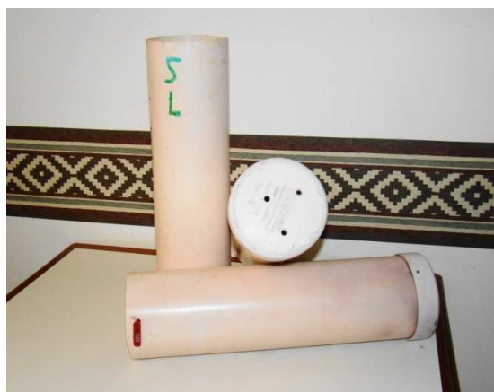
Fig. 1: Tubos para simulación de riego con sus perforaciones para drenaje e identificación (como se aprecia un elemento sumamente sencillo)
