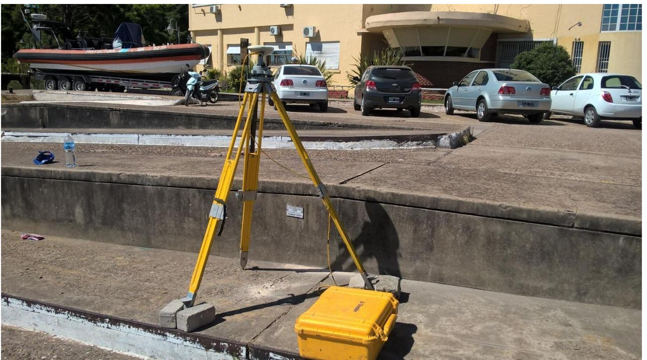
*Figura 6.12. Relevamiento altimétrico con GPS Diferencial - Zárate*
