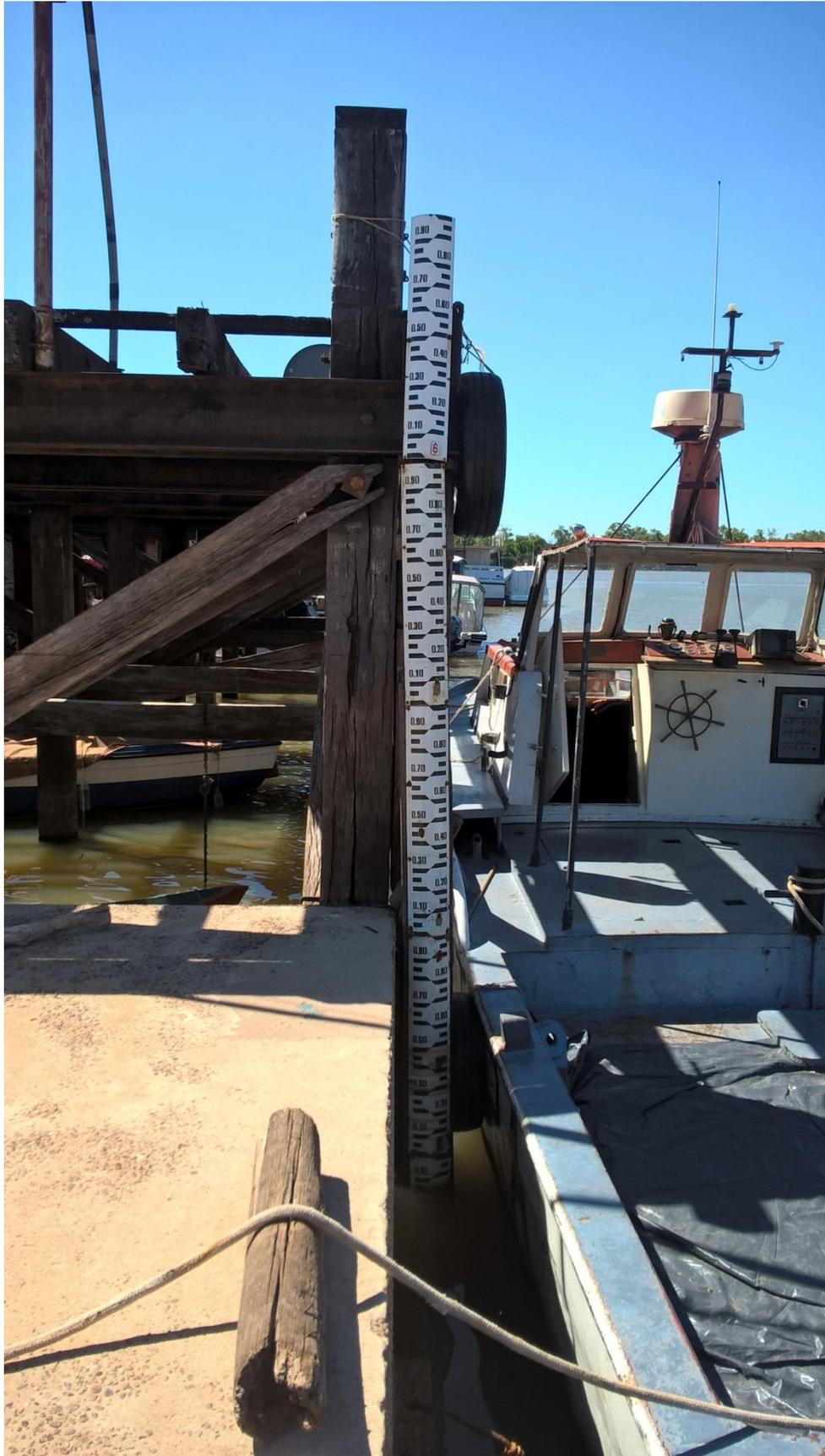
*Figura 6.70. Escala hidrométrica– Paraná*
