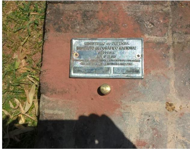
Figura 3.3. Punto de la Red de Nivelación de Alta Precisión (izq.). Bulón instalado próximo al instrumental hidrométrico (der.)
