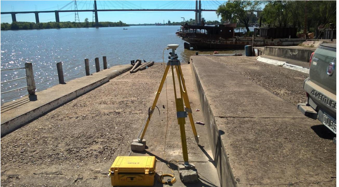
*Figura 6.11. Relevamiento altimétrico con GPS Diferencial - Zárate*
