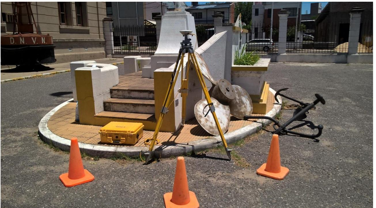
*Figura 6.67. Relevamiento altimétrico con GPS Diferencial - Paraná*
