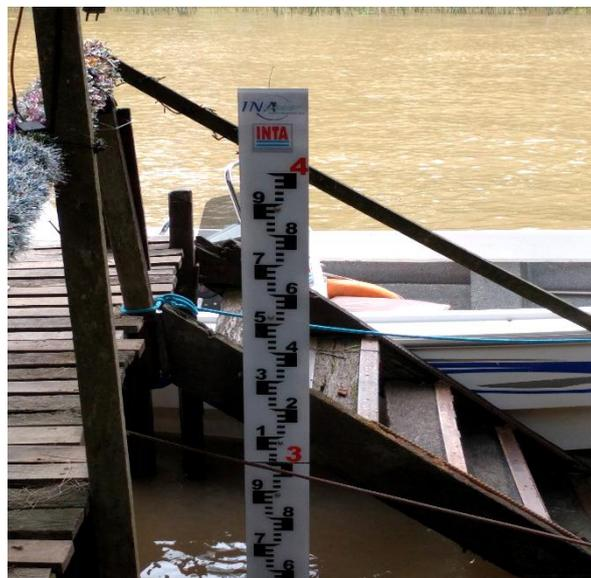
**Figura 6.-** Escala hidrométrica INA-INTA, ubicada en el predio del referente local Zemek
