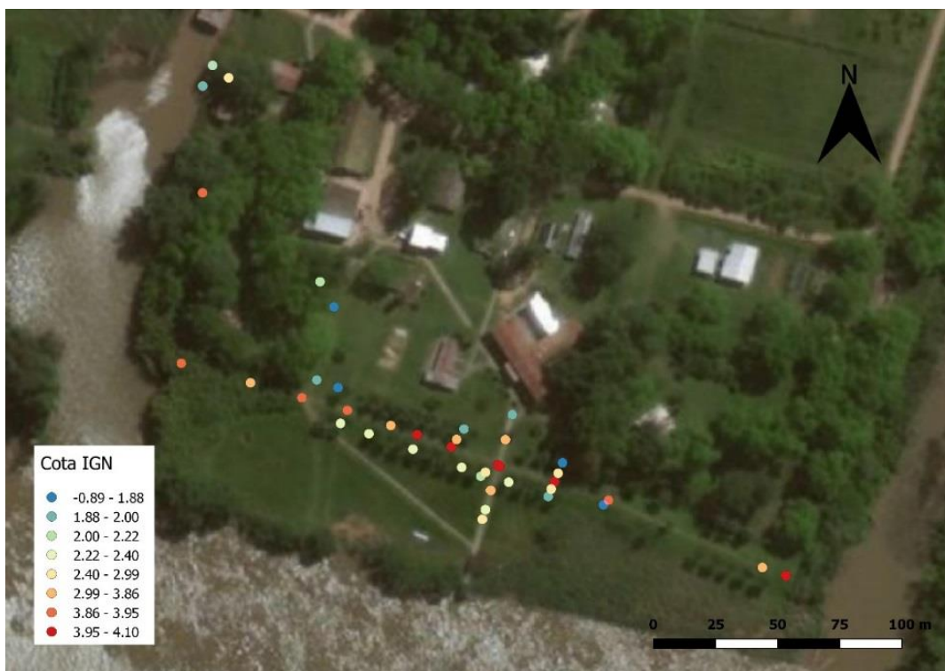
Figura 15.-Puntos Relevados con sus Cotas IGN post procesados y visualizados en GIS
