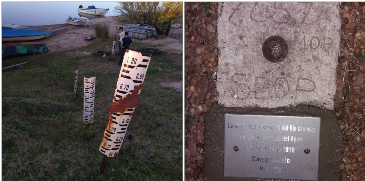
Figura 2.4. Escalas hidrométricas (izquierda), bulón existente y placa instalada (derecha)
