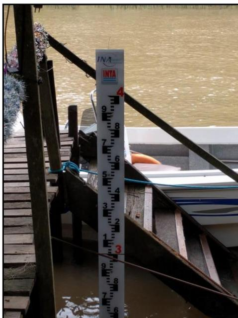
**Figura 5.-** Lectura de nivel de agua mediante escala hidrométrica.
