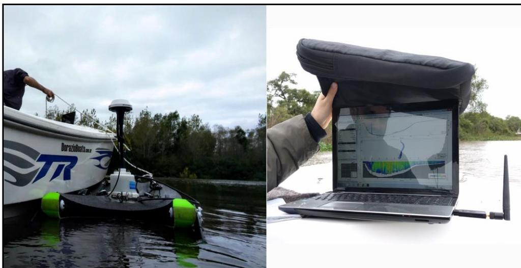
**Figura 4.-** Toma de datos batimétricos y caudal mediante dispositivo ADCP.
