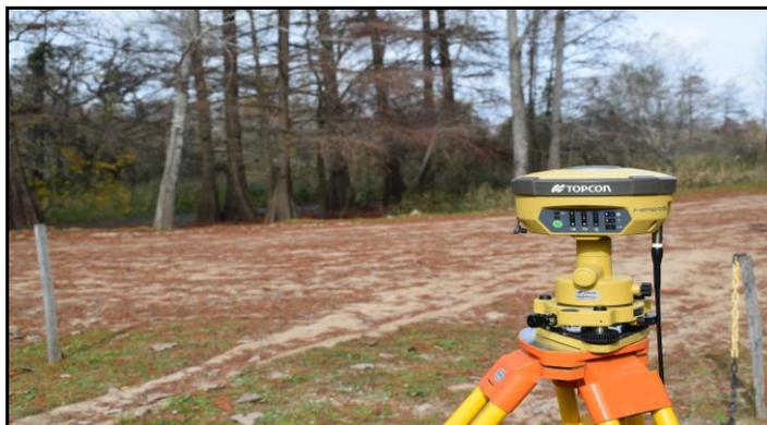
**Figura 3.** Relevamiento de mediciones de cotas con uso de GPS Diferencial.
